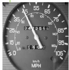
El velocímetro de un automóvil da la velocidad en un intervalo de tiempo muy corto, así que su lectura se aproxima a la velocidad instantánea
